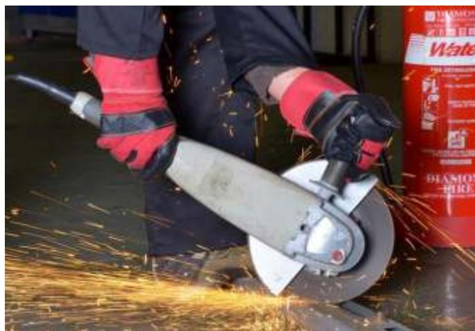
Upotreba električnog alata (brusilica)
